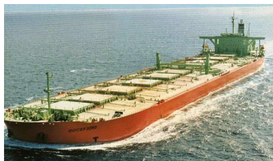
Figura 5 -Docefjord, maior navio construído pelo Ishibrás, 305.000 DWT
